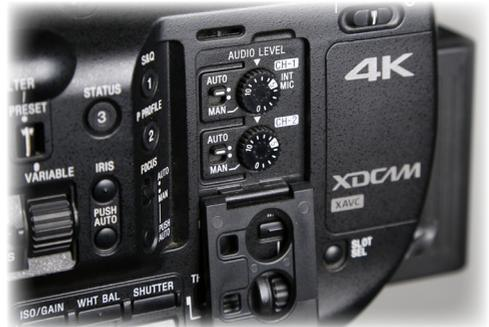
Der Kanal 1 sollte auf Manuell. Dies bedeutet, dass der Audiopegel vom Bediener selbst eingestellt = angesteuert werden muss. Kanal 2 kann für Atmo-Mic auf AUTO betrieben werden. Nur bei einer richtigen Aussteuerung (nicht zu leise / nicht zu laut) ist das Audiosignal brauchbar.
